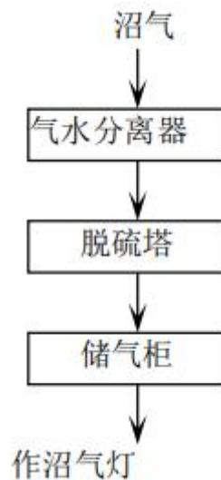
图 6-1 沼气收集工艺流程图
